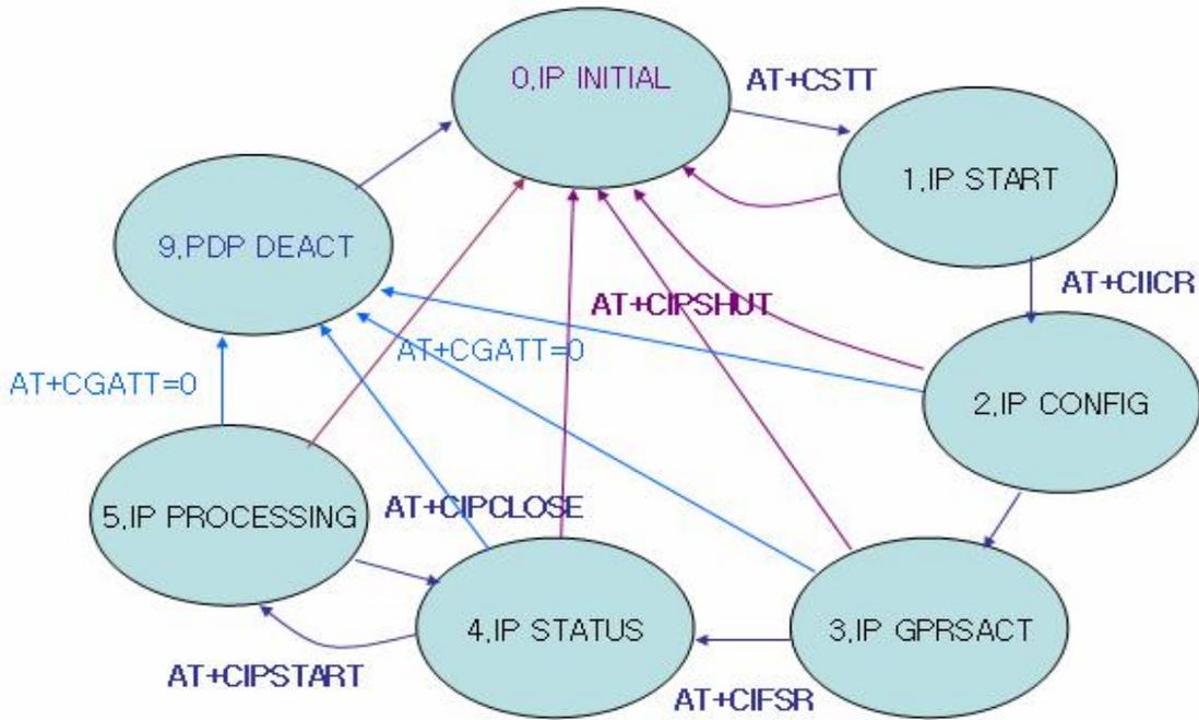
图 2 : 多链接时的状态机
